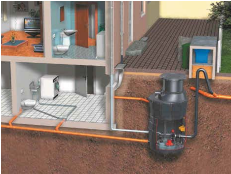
Bild 5-13 Beispiel für eine trockene Pumpenaufstellung in einem Pumpenschacht bei fäkalienhaltigem Abwasser Werkbild: Kessel, Lenting
