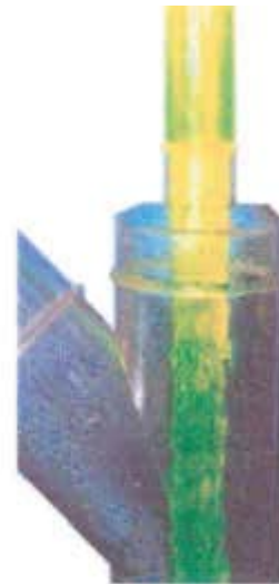
Bild 6-73 Freistrahle im Mündungsbereich einer Druckentwässerungsanlage
