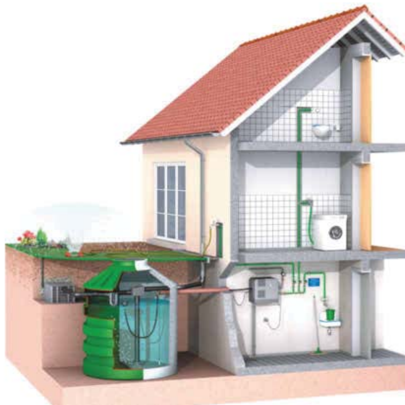
Bild 5-10 Regenwassernutzungsanlage Werkbild: Fachvereinigung Betriebs- und Regenwassernutzung e. V., Darmstadt
