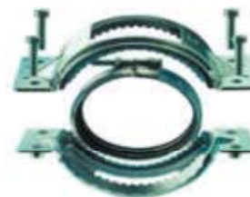
Bild 6-9 PAM-GLOBAL® Unigrip-Kralle längskraftschlüssige Sicherungsschellen (PAM-Global REKORD-Kralle) DN 50 bis 300 aus Stahl, galv. verzinkt, für Abwasserleitungen aus dem Werkstoff Guss für die Verbindung mit PAM-Global Rapid- und CV-Verbindungen bei Innendruck bis zu 1000 kPa (10 bar) bis DN 100, 5 bar bis DN 150 und 3 bar bei DN 200; so gesicherte Abwasserleitungen können z. B. auch als Druckleitungen bis DN 100 nach einer Abwasserhebeanlage verwendet werden Werkbild: Saint-Gobain HES, Köln
