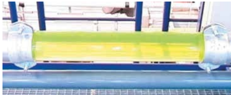
Bild 14-74 Kontrollstücke zur Begutachtung der Strömungsverhältnisse in der Versuchsanlage
