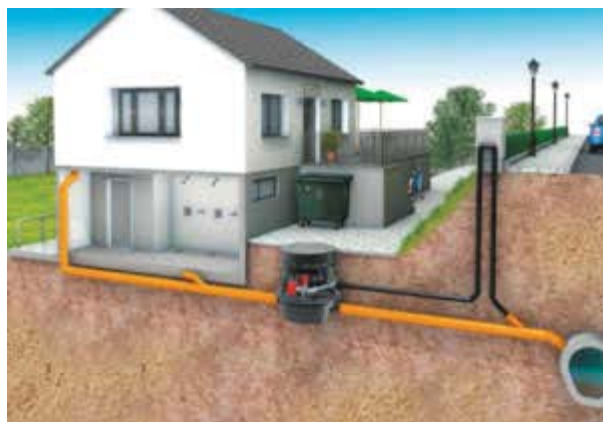
Bild 4-7 Rückstaubetrieb mit Entwässerung: Die Entwässerung erfolgt über eine den Rückstauverschlüssen vorgeschaltete Abwasserhebeanlage Werkbild: Kessel, Lenting
