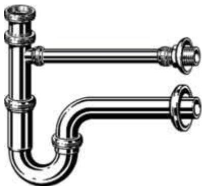
Bild 5-17 Geruchverschluss für Waschtisch/Handwaschbecken mit Leckwasseranschluss Werkbild: Viega, Attendorn
