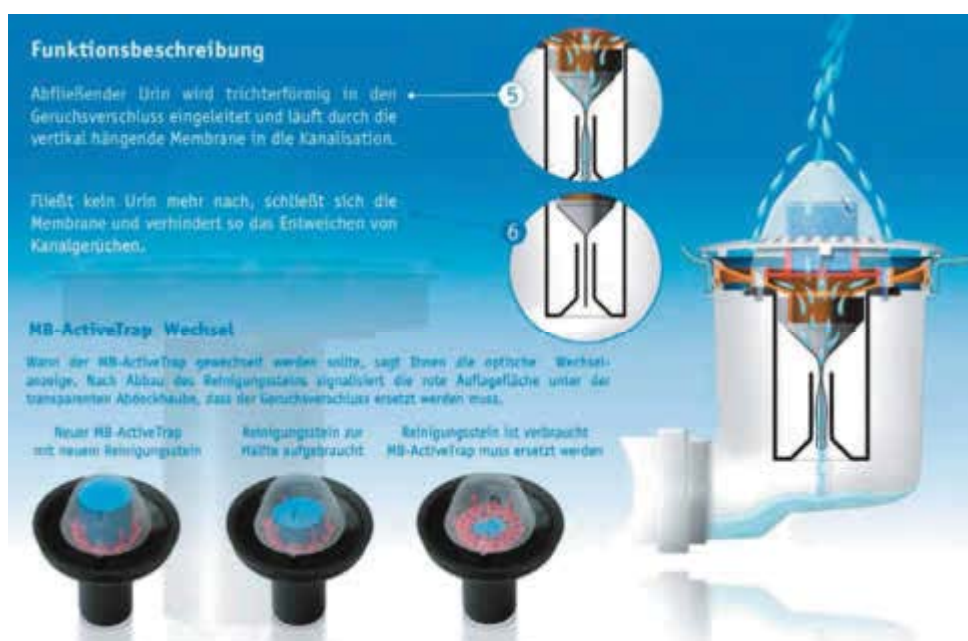
Bild 5-9 Wasserloses Urinal mit schlauchförmiger Quetschmembrane als Geruchverschluss Werkbild: URIMAT Deutschland AG, Hundsangen
