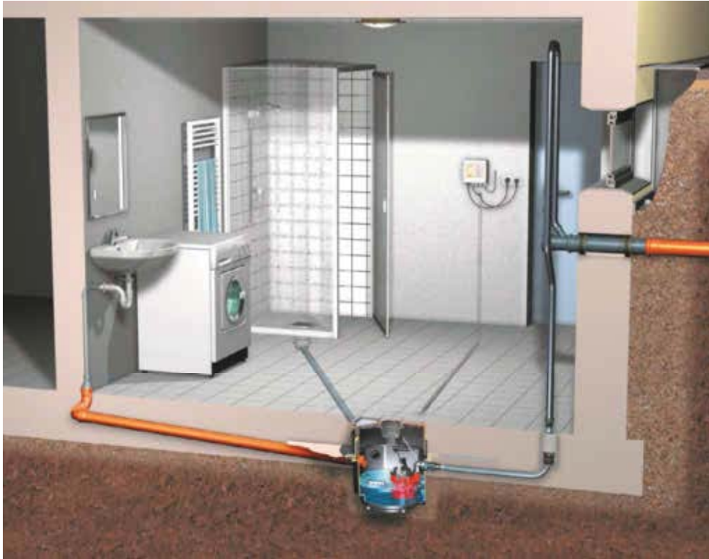
Bild 8-2 Bodenablauf mit integrierter Pumpe für fäkalienfreies Abwasser, zum Erdeinbau in frostgeschützten Räumen unterhalb der Rückstauenebene Werkbild: Kessel, Lenting
