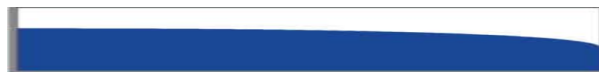
Bild 14-88 Wasserspiegellinie bei einer waagrecht verlegten Rinne (Computerberechnung) mit freiem Ablauf über die Rinnenstirnseite
